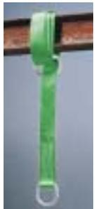
Cinta para vigas/travesaño de 6' (1.8m) se envuelve en vigas I u otras estructuras, se conecta pasando un Anillo D de 2 pulgadas (50mm), a través de un Anillo D de 3 pulgadas (76mm), para formar un punto de conexión seguro para líneas de vida y otros dispositivos de conexión. **Modelo 8183/6FTGN** con máxima capacidad de 400 libras (181.4kg)
