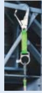
Diseñado para facilitar el Anclaje en andamios, tuberías o ángulos de hierro y presenta una gancho de cierre estructural, para instalación sencilla mediante una mano, y un Anillo D en el otro extremo para acoplar el dispositivo de conexión. **Modelo 480/19INGN** con máxima capacidad de 400 libras (181.4kg).
