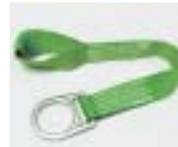
La cinta de Anclaje disponible en concreto tiene un diseño único que brinda Anclaje temporal en concreto formado. Construida de cinta resistente a la abrasión con ancho de 1-3/4 de pulgada (44mm). El Anillo D de acero forjado (**Modelo 8185C**) es capaz de cargar 5,000 libras (22kN). Dimensiones estándar de 2 pies (.6m) y 4 pies (1.2m); dimensiones adicionales disponibles. También disponible con lazada; (incluye soporte interno para desgaste para ser utilizado con mosquetones) **Modelo 8185CX**.
