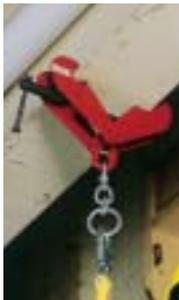
La abrazadera para vigas es un punto de Anclaje de acero que puede ser conectada a una vigas horizontales tipo I, S o W. Su anillo giratorio impide el enrollamiento del dispositivo de conexión del trabajador. El **Modelo 450** se acopla a vigas con un ancho máximo de 9 pulgadas (229mm). El **Modelo 455** se acopla a vigas con un ancho máximo de 12-1/2 pulgadas (318mm). Con máxima capacidad de 400 libras (181.4kg)
