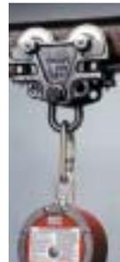
Trolley para Vigas I es ajustable y se desliza junto con el trabajador para brindar máxima movilidad. El equipo ligero de trolley para vigas I (**Modelo 9065**), se ajusta a vigas de ancho de 3 pulgadas (76mm) a 4-1/2 pulgadas (114mm). **Modelo 9065-1** se acomoda a vigas I con ancho hasta de 8-1/2 pulgadas (216mm). **Modelo 9065-2** se acopla a vigas I con ancho de hasta 12 pulgadas (305mm). Máxima capacidad de 400 libras (181.4kg)
